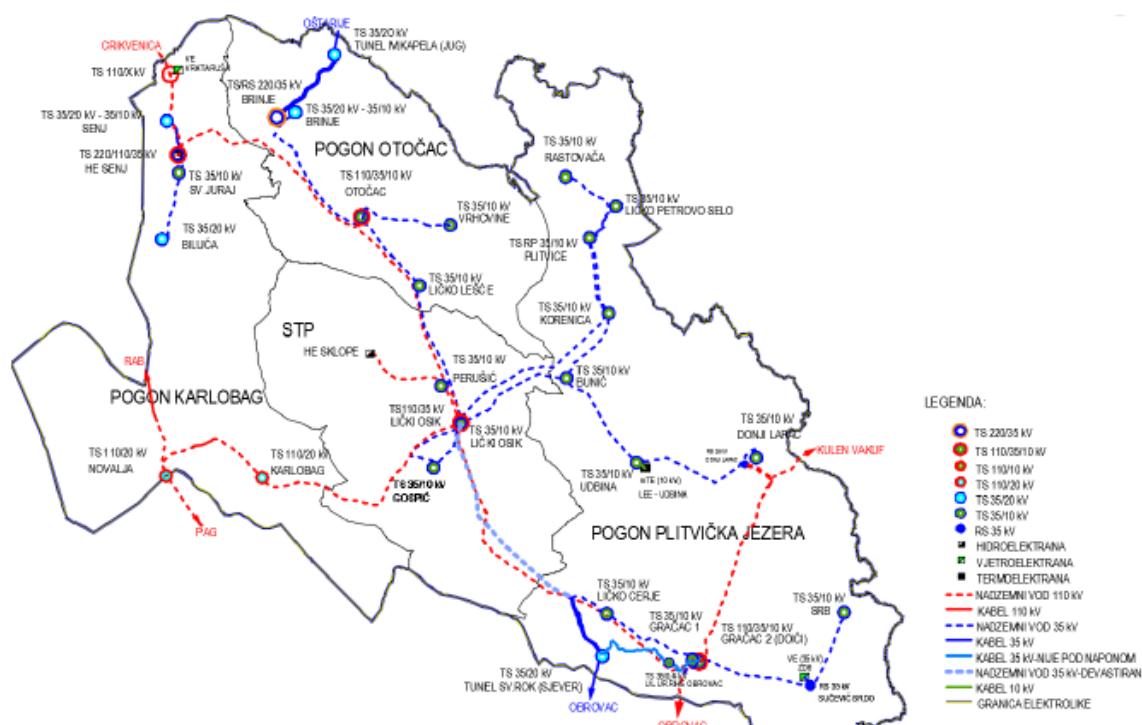
Slika 1. Shematski prikaz 110 kV i 30(35) kV mreže distribucijskog područja
